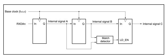
Figure 15-15. Noise Filter Circuit
