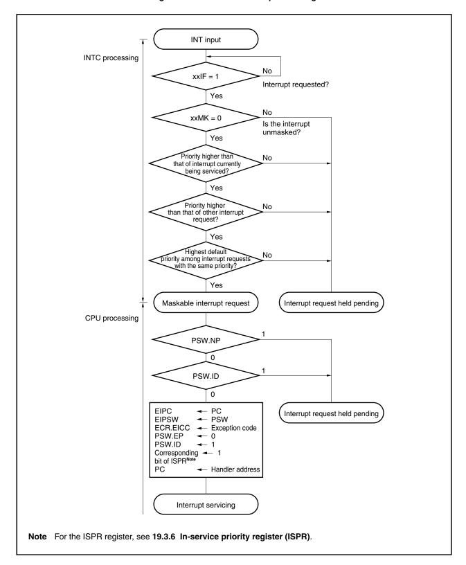
Figure 19-5. Maskable Interrupt Servicing
